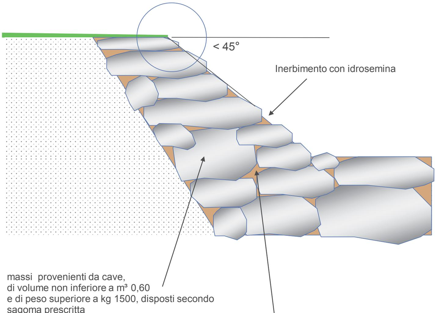
Intasamento dei vuoti con terra agraria, versata a strati sopra ogni corso di massi, ripulendo le superfici, onde evitare di diminuire il coefficiente di attrito tra i blocchi.
