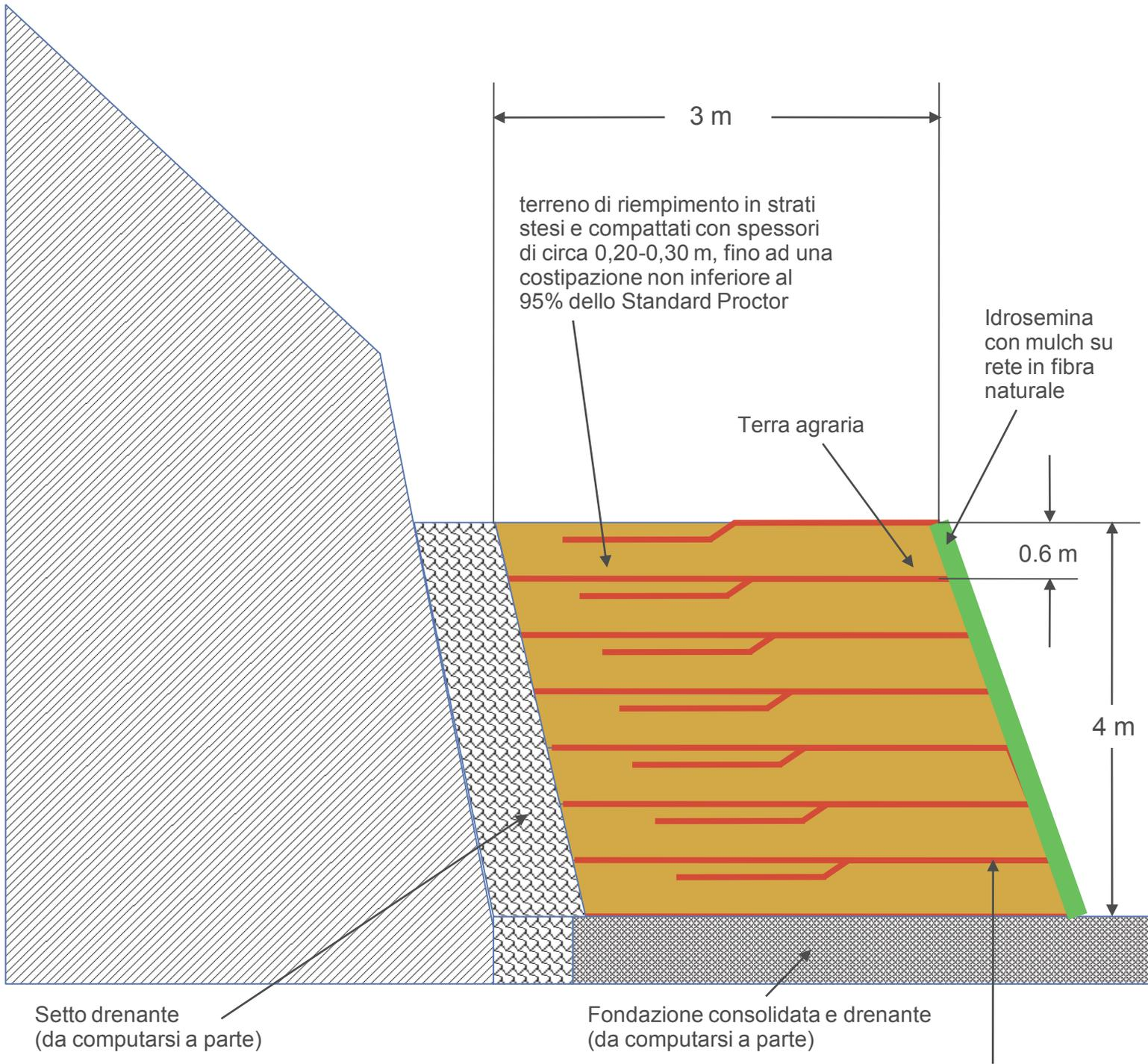
geogriglie monorientate in poliestere, polietilene o polipropilene estruso e stirato longitudinalmente aventi alta resistenza meccanica e notevole inerzia chimica, fisica e biologica, e stabilizzati all'azione dei raggi U.V., con resistenza a trazione 100 kN/m longitudinale
