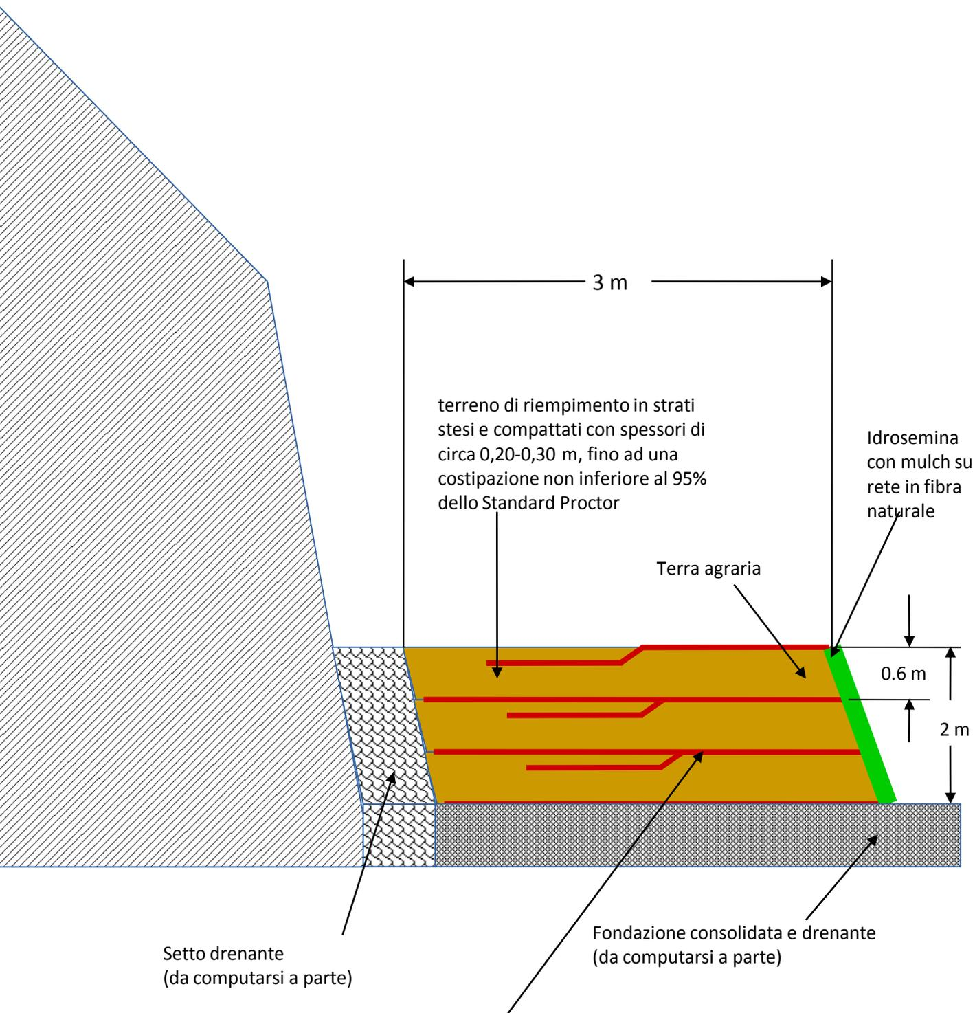
geogriglie monorientate in poliestere, polietilene o polipropilene estruso e stirato longitudinalmente aventi alta resistenza meccanica e notevole inerzia chimica, fisica e biologica, e stabilizzati all'azione dei raggi U.V., con resistenza a trazione 100 kN/m longitudinale
